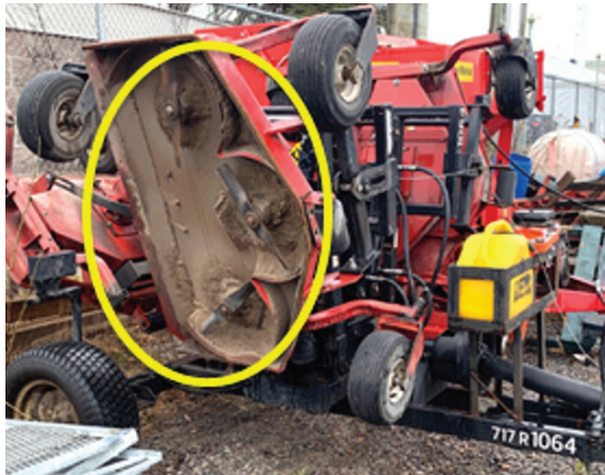
Photo 3 : Tondeuse sur remorque qui a été remise tout l'hiver à l'extérieur sans que la section lame de coupe ait été nettoyée
