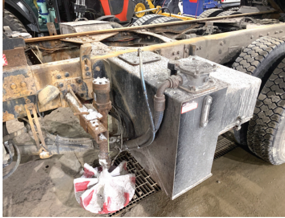
Photo 1 : Camion épandeur stationné à l'intérieur et couvert de calcium
