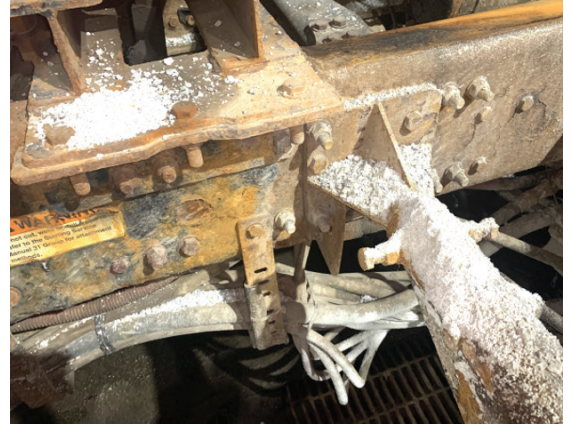
Photo 2 : Autre camion épandeur stationné à l'intérieur et couvert de calcium
