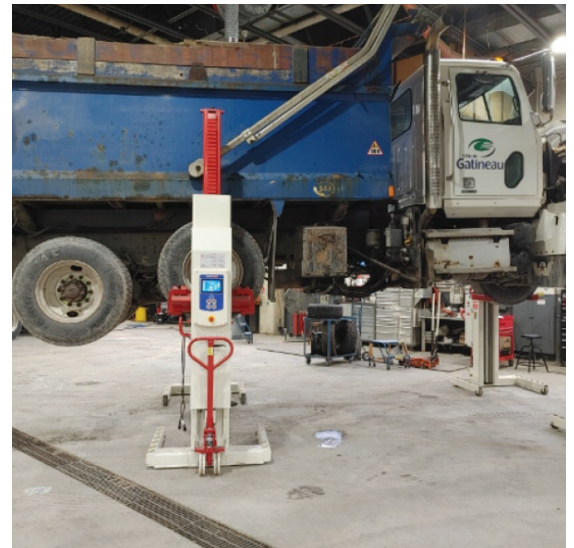
Photo 16 : Essieux arrière supportés par une seule colonne mobile (atelier de Hull)
