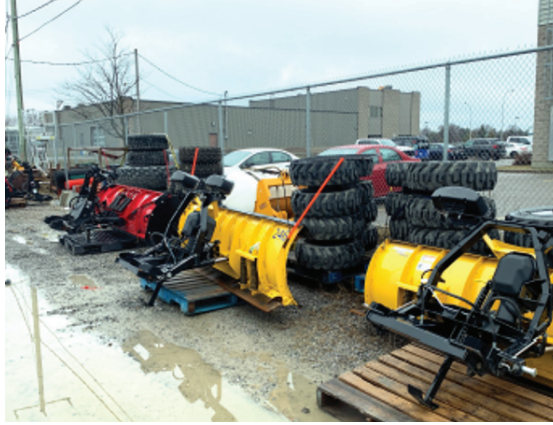
Photo 9 : Pneus gardés à l'extérieur qui ne sont pas protégés des intempéries (atelier de Hull)
