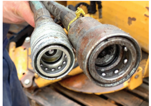
Photo 8 : Véhicule remis à l'extérieur et dont les extrémités des boyaux n'ont pas été scellées
