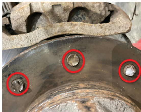
Photo 12 : Vis retenant la roue qui ont cédé pendant que le véhicule roulait et la roue s'est détachée
