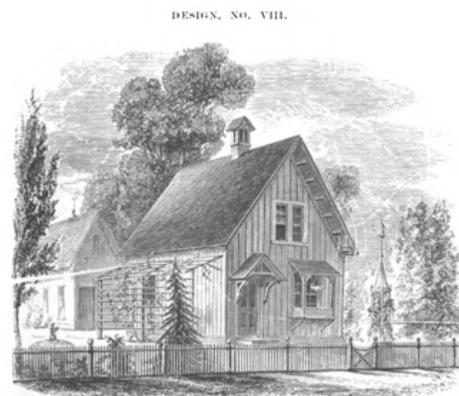
28. Modèle de maison d'un étage et demi à mur pignon frontal, tirée de l'ouvrage d'Henry Cleaveland et des frères Backus.
